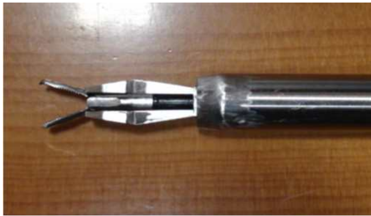
그림6. 속집게 장착 지혈클립장치 기존 시제품
