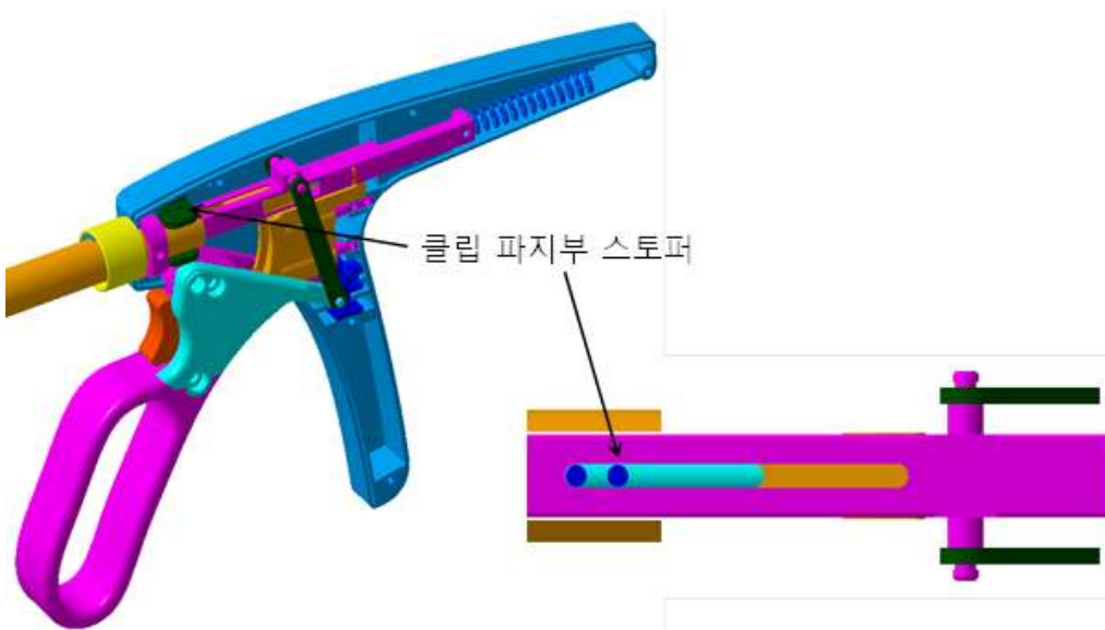
그림5. 클립 파지부는 멈추고 클립 가압부만 움직이도록 하는 메커니즘
