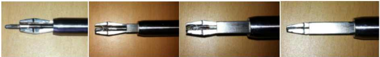
그림9. 개선된(2차) 속집게 장착 지혈클립장치 시제품의 가압 메커니즘
