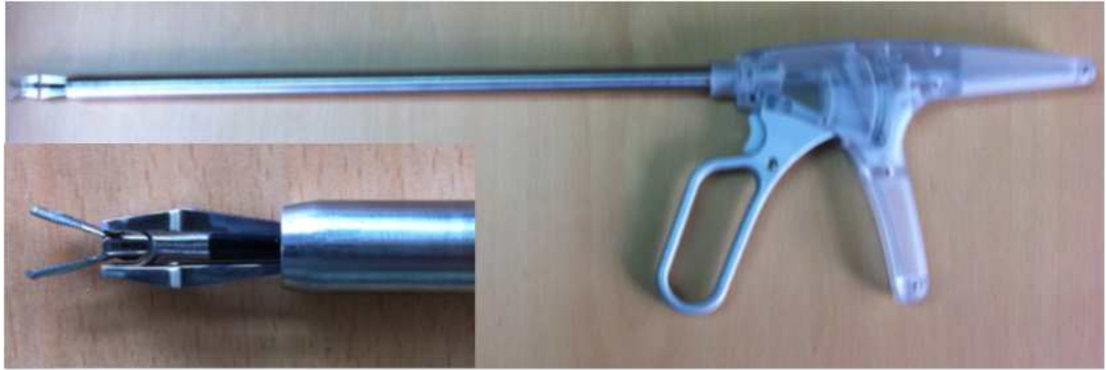
그림8. 개선된(2차) 속집게 장착 지혈클립장치 시제품
