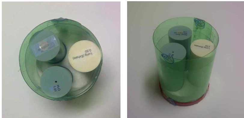
그림 25. 실린더 팬텀 안에 물, 폐, 뼈의 상대적 전자밀도를 가지는 rod 팬텀을 세워둠.
