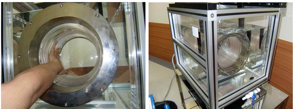
그림 4 빔 에너지 변조 물팬텀. 팬텀 안에 공기로 차있는 튜브가 팽창 및 수축하며 물두께를 조절하고 해당하는 물 두께만큼 에너지를 잃으며 에너지가 변조됨.
