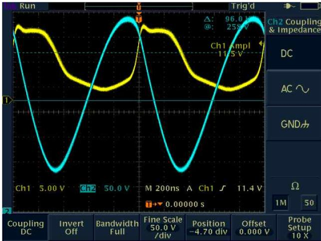
그림 16: Oscilloscope 상에 측정된 buncher내부의 rf 파형.
