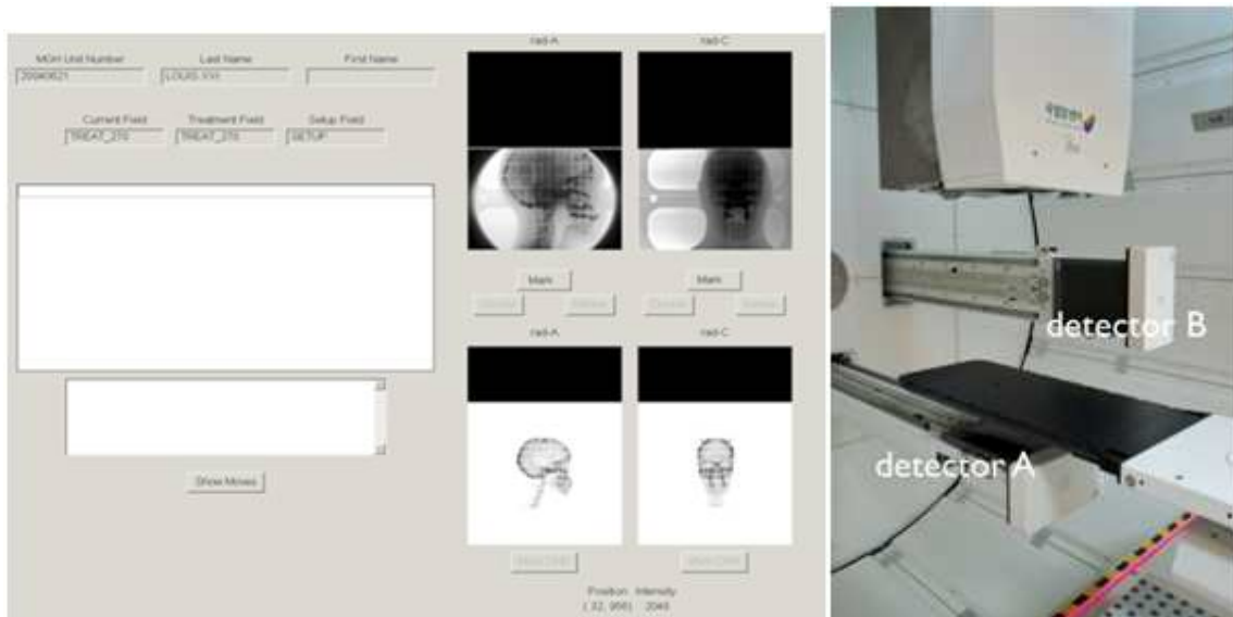
그림 1. 현재의 양성자치료시스템에서 환자의 위치를 교정하는 프로그램. 90도를 이루는 두 영상을 가지고 치료계획에 사용된 CT 블록데이터를 이용해서 만든 DRR 영상과 위치의 비교를 통해 가장 최적의 환자의 치료위치를 결정한다. 현재 모든 과정이 수동으로 진행된다. 우측의 사진은 90도로 회전되어 있는 두 디텍터를 나타낸다.
