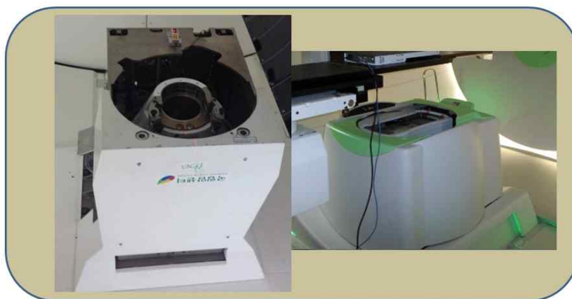
그림 4. 왼쪽은 국립암센터 양성자치료실 노즐 오른쪽은 IBA최신 MLC가 장착된 노즐
