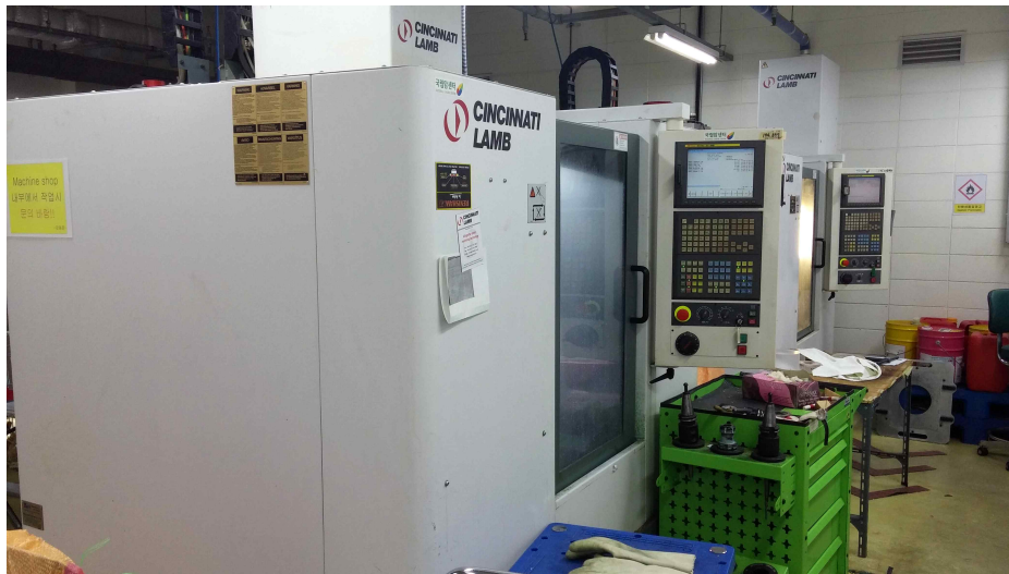
그림 3. 블록 및 거리보상체 가공을 위한 정밀가공 밀링머신
