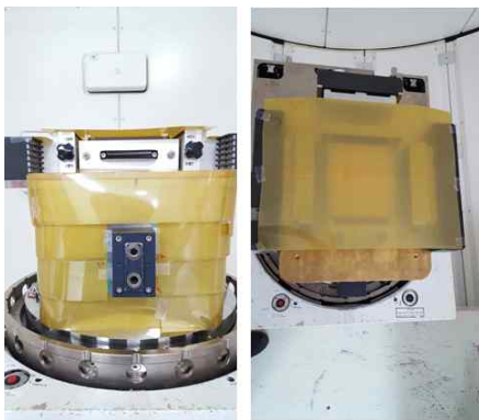
그림 16. Wobbling snout에 제작한 다엽콜리메이터를 장착하고 난 후 차폐 테스트
