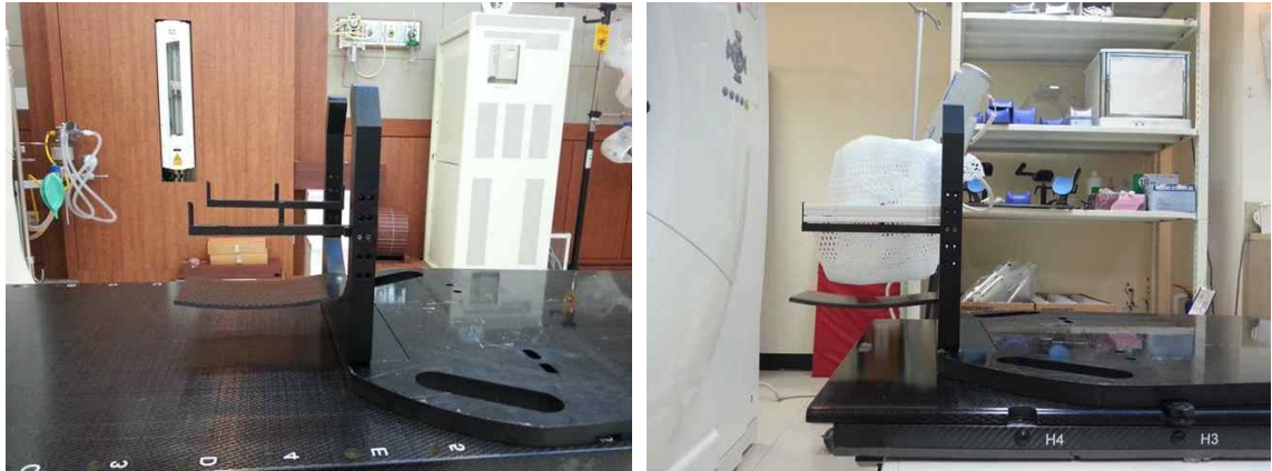
그림 18 Brainlab 프레임의 환자고정장치를 장착한 TOMO couch의 모습
