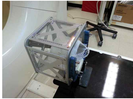
그림 16 Brainlab 프레임과 고정장치, lockbar를 이용하여 CT에 장착한 모습
