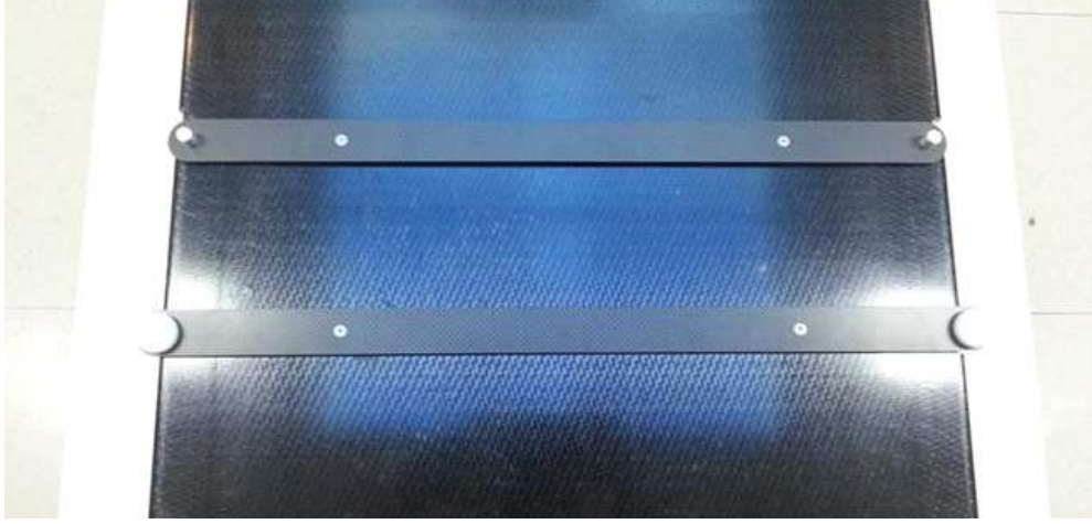
그림 13 CT/TOMO용 고정대(lock bar)의 제작
