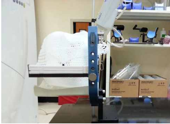
그림 16 Brainlab 프레임과 고정장치, lockbar를 이용하여 CT에 장착한 모습
