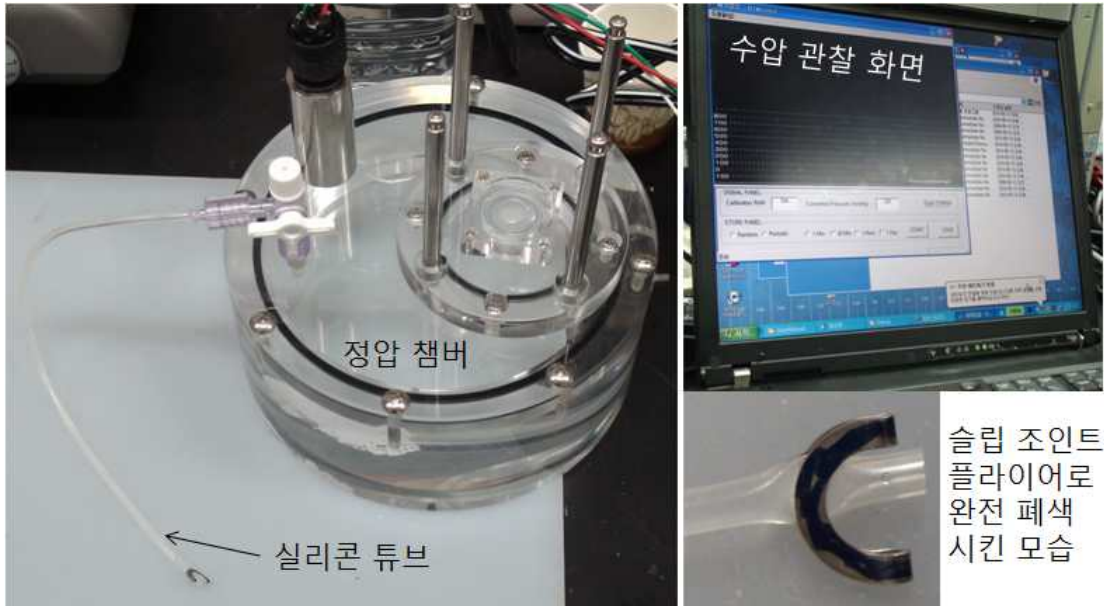
그림2. 폐쇄형 지혈 클립의 밀폐 성능 확인 실험
