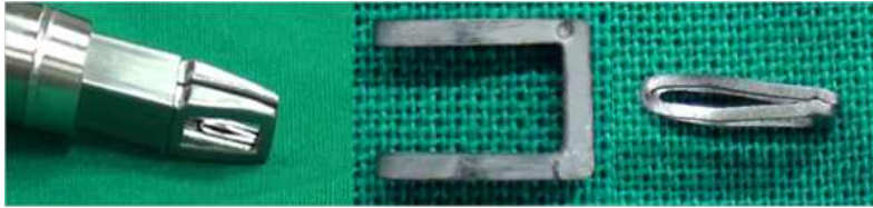
그림9. 지혈 클립 2차 시제품을 클리핑한 모습
