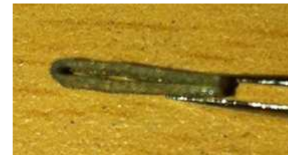
그림 13. 지혈 클립 3차 시제품을 클리핑한 모습
