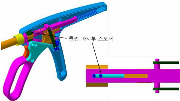
그림18. 클립 파지부는 멈추고 클립 가압부만 움직이도록 하는 메커니즘
