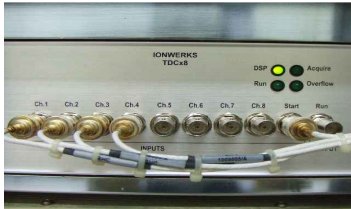
그림 5. Upgrade 된 TDC pannel
